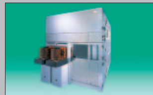
EPD-Xシリーズ 半導体デバイス工程への本格的導入が期待される端面研磨装置
